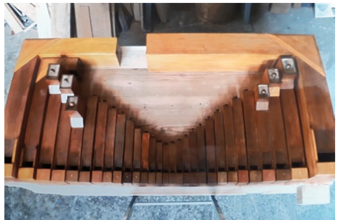
Abb. 6: Aufgearbeitetes Pfeifenwerk im Boden
