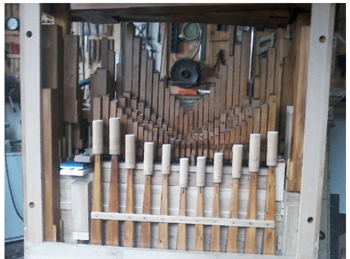
Abb. 5: Ein Lichtblick – aufgearbeitetes Pfeifenwerk im neuen Rahmen
