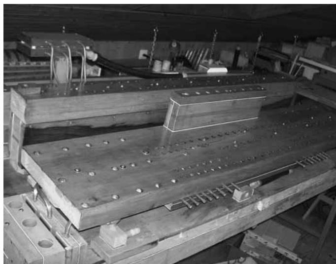
Vorderansicht der Windlade nach der Restaurierung. Zu sehen ist der große Pfeifenstock für die Melodie und Gegenmelodie mit den Abgängen für das Glockenspiel. Dahinter der Fortestock, auf dem die Mixturpfeifen zu stehen kommen. Zwischen den beiden Stöcken ist der Platz der beiden Begleitregister Cello 8' und Gedackt 8', die auf einem Überstock direkt auf der Lade stehen. Links unten befindet sich eine kleine Zusatzlade für die Posaunen.
