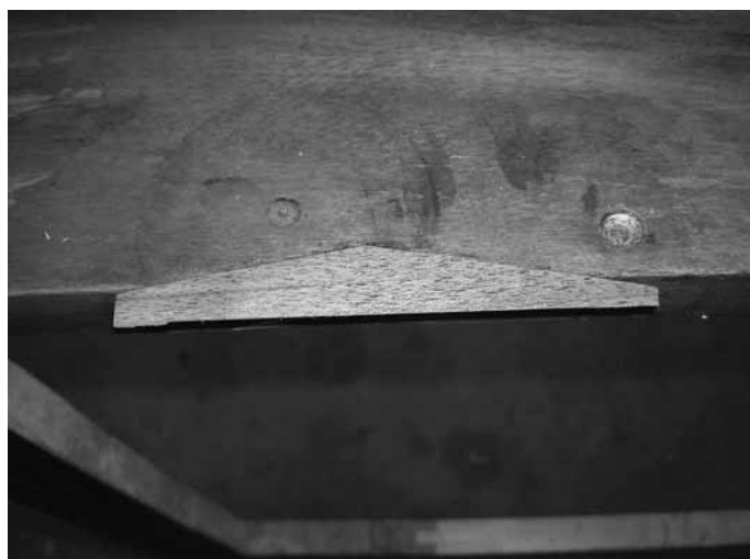
Einsetzen eines Furnierstücks Foto: Archiv Orgelbau Fuchs GmbH
