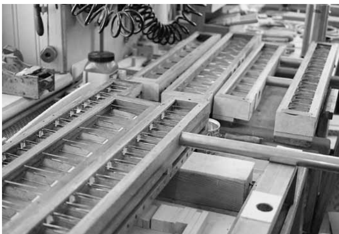
Kanzellen der Windlade mit neuen Ventilen
