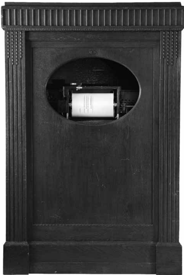
Das preiswerte „Kriegs-Modell Clavirist-Orchester III“ der Ludwig Hupfeld A.-G. aus dem Jahr 1915 in sehr einfacher Ausstattung gefertigt: ein Klavier-Mechanismus mit 62 Tönen, Xylophon (10 Töne) und Harfen-Effekt (Holzleiste mit Lederstreifen). GRASSI Museum für Musikinstrumente der Universität Leipzig, Inv.-Nr. 4489
