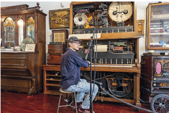
Abb. 5: Studierende lassen manuell die Töne erklingen und nehmen mit einem Stereo-Mikrofon den Klang des Orchestrions auf. (Foto: Golo Föllmer)
