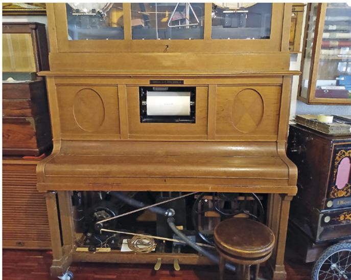
Abb. 1: Untere Frontansicht des Orchestrions. Man erkennt Teile der Antriebstechnik (inklusive Schlauch zum cleveren Staubsauger-Antrieb von Jost Mucheyer) und über der eingelegten Notenrolle die Plakette mit der Nennung des Klavierzulieferers. (Foto: Aiko Herrmann)
