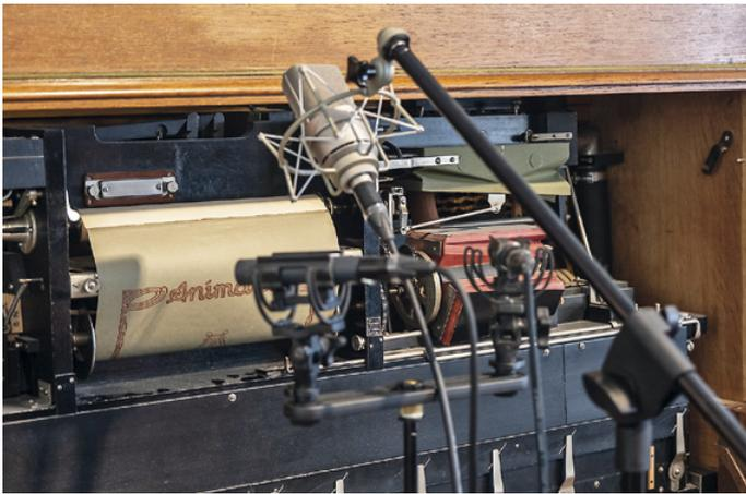
Abb. 7: Der Aufbau aus einem Großmembranmikrofon mit zwei stereo gerichteten Kleinmembranmikrofonen erzeugt sehr plastische Aufnahmen, welche das beste Ergebnis für das Sampling der Studierenden liefern. (Foto: Golo Föllmer)
