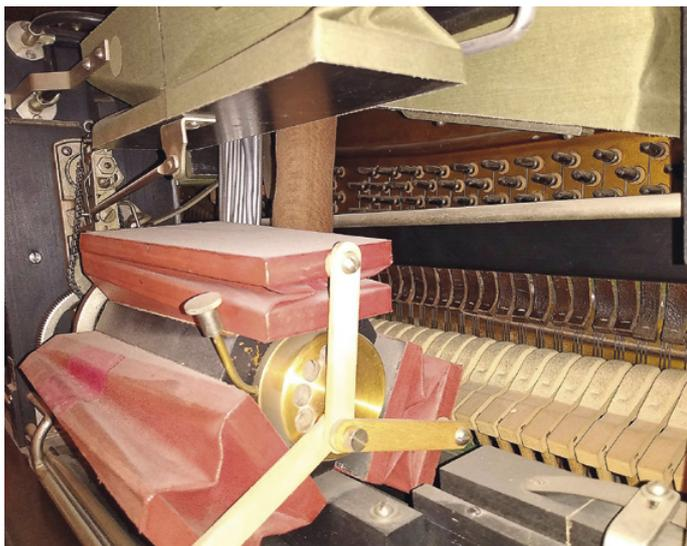
Abb. 2: Rechts über den Klavierhämmern sind die mit Metall versehenen Lederstreifen sichtbar, die den Mandolinen-Effekt ermöglichen. Vergleichbares könnte Henry Cowell und John Cage zu weitergehenden Experimenten mit dem Klavierklang angeregt haben. (Foto: Aiko Herrmann)
