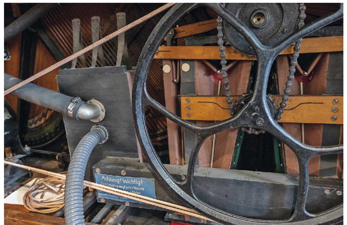
Abb. 4: Jost Mucheyer brachte den unteren Stutzen an und verband ihn mit einem Staubsauger im Nebenraum. Die modifizierte Pneumatik des Gerätes verringert die Störgeräusche auf ein Minimum. (Foto: Golo Föllmer)
