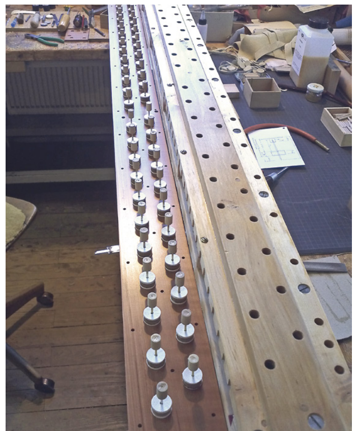
Vorpneumatik mit montierten Ventilen
