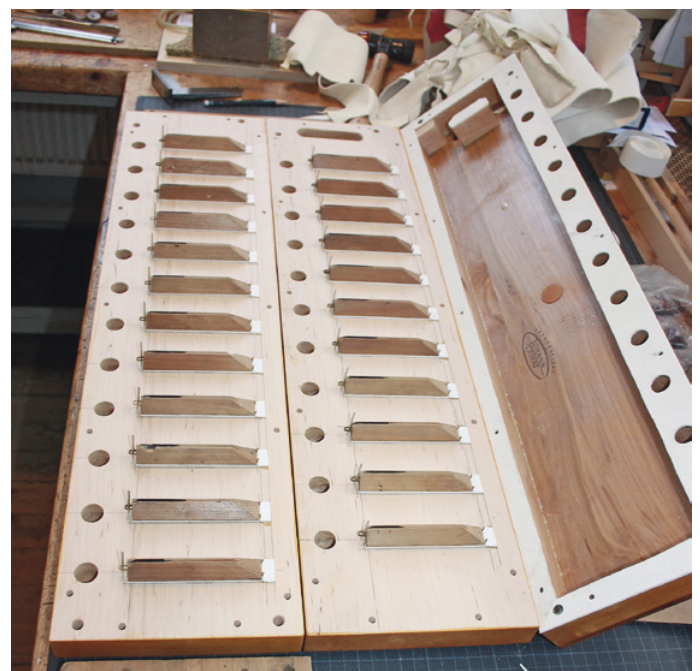
Die nachgefertigte Ventillade, aus Roterlenholz
