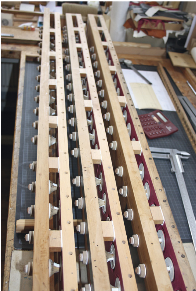
Membranen und Ventile in den Laden montiert, vor dem Verschließen der Laden
