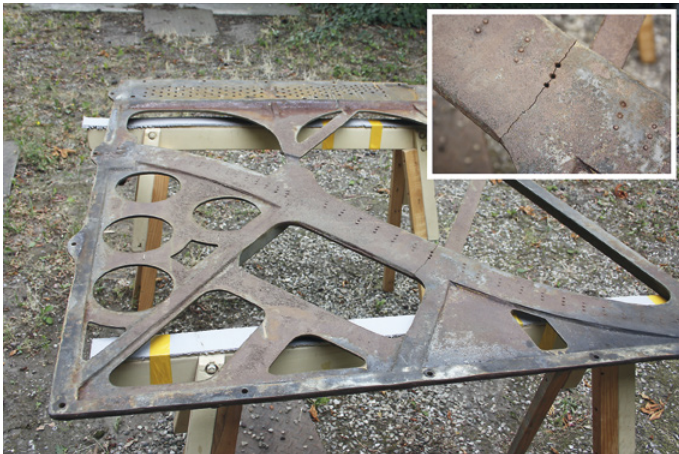
Originalzustand der Klavier-Gussplatte, sowie Details mit sichtbaren Rissen
