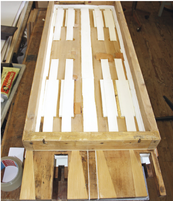
Mit eingepassten und schräg angesetzten Hölzern ergänzte Balglager
