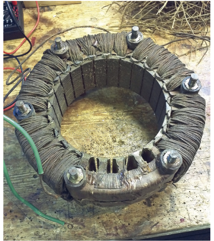
Kollektor des Repulsionsmotors mit durchgebrannter Originalwicklung (0,7 mm Kupferdraht, isoliert mit 4 Lagen Seidenfaden)
