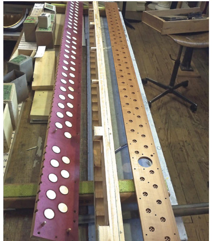
Rekonstruierte Vorpneumatiklade, sichtbar die Membranen-Ebene
