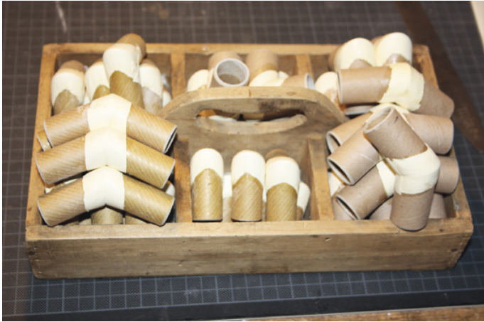
Vorgefertigte Eckverbinder für die Kartonrohre
