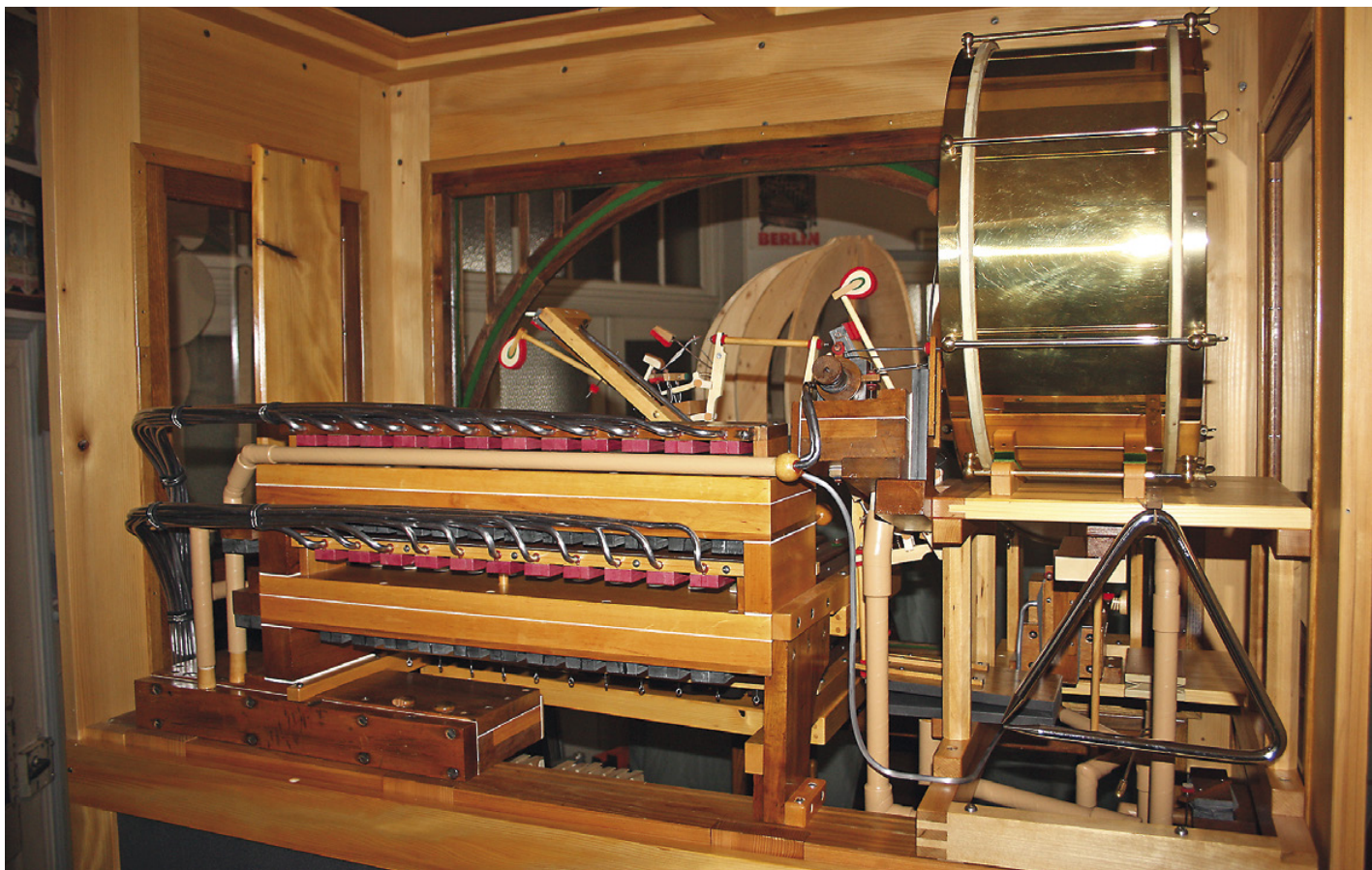
Pneumatische Ansteuerung vom Xylophon mit Bleirohr
