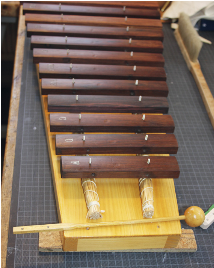
Xylophon-Klanghölzer aus indischem Palisander, auf dem Resonanzboden traditionell auf Strohlagern gesetzt
