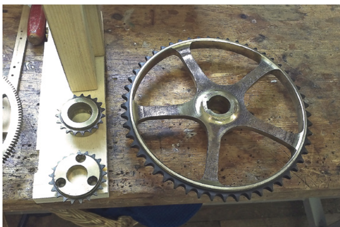
Kettenräder mit neuen Zahnkränzen
