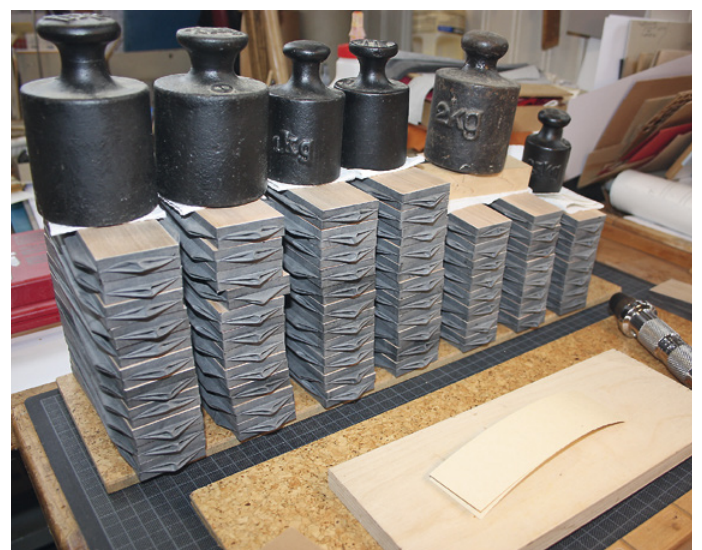
Bälgechen der Tastenbetätigung, bereit für den Einbau
