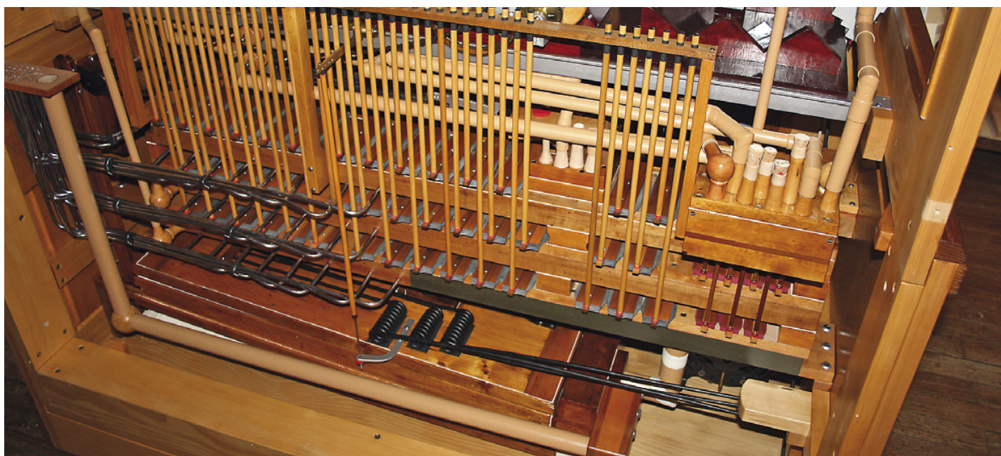
Bleirohrverlegung hinter der Windlade bei ausgebautem Klavier
