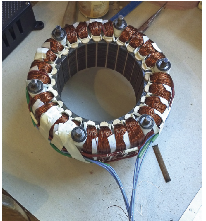
Kollektor, neu gewickelt mit modernem Motorendraht
