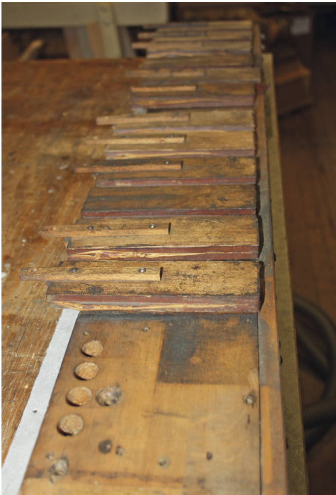
Die mittlere Ebene der dreiteiligen Hauptwindlade nach Vorreinigung
