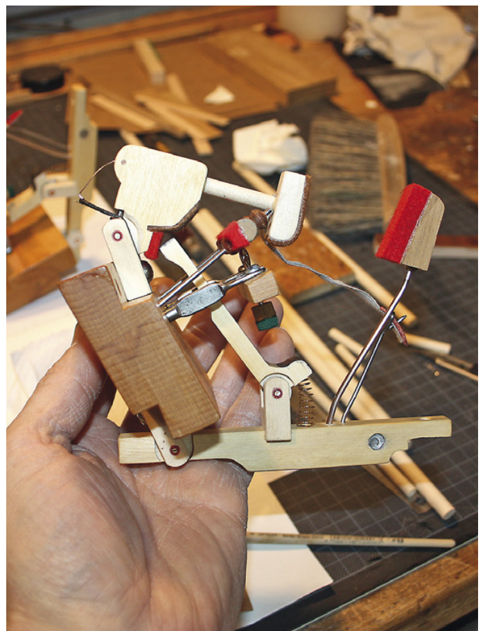
Angefertigte Mechanikteile für den Trommelschlag aus Weißbuche mit Kerntuchlagern
