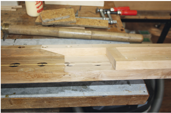
Ladenbrett, angesetztes Endstück, da die Lade zum Ausbau abgesägt wurde
