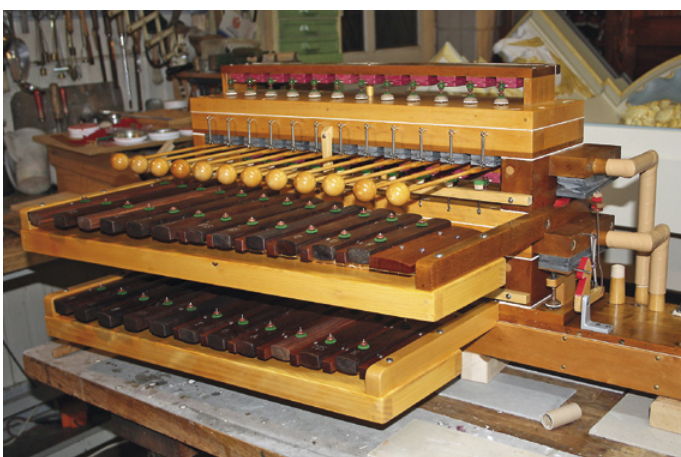
Die fertiggestellte Xylophoneinheit: Die dunkleren Hölzer sind wiederverwendete Originalteile.
