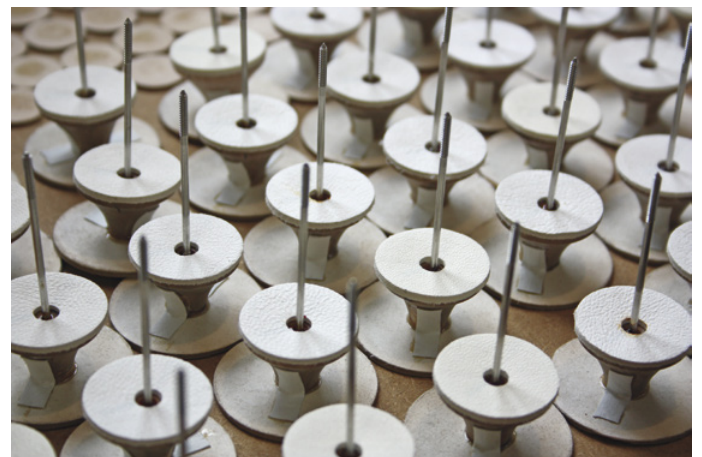
Originalventile, überarbeitet und beledert, warten auf den Einbau.
