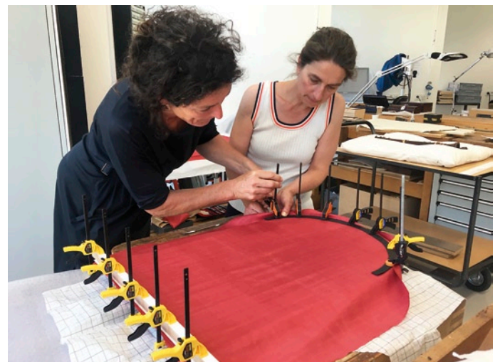
Abb. 12: Aufbringen des neuen Seidenstoffs auf die Seitenteile
