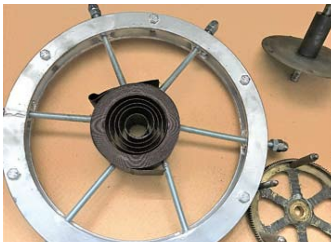
Abb. 2: Stahlring-Vorrichtung mit Schrauben zum Sichern und Ausbau der beschädigten Aufzugsfeder
