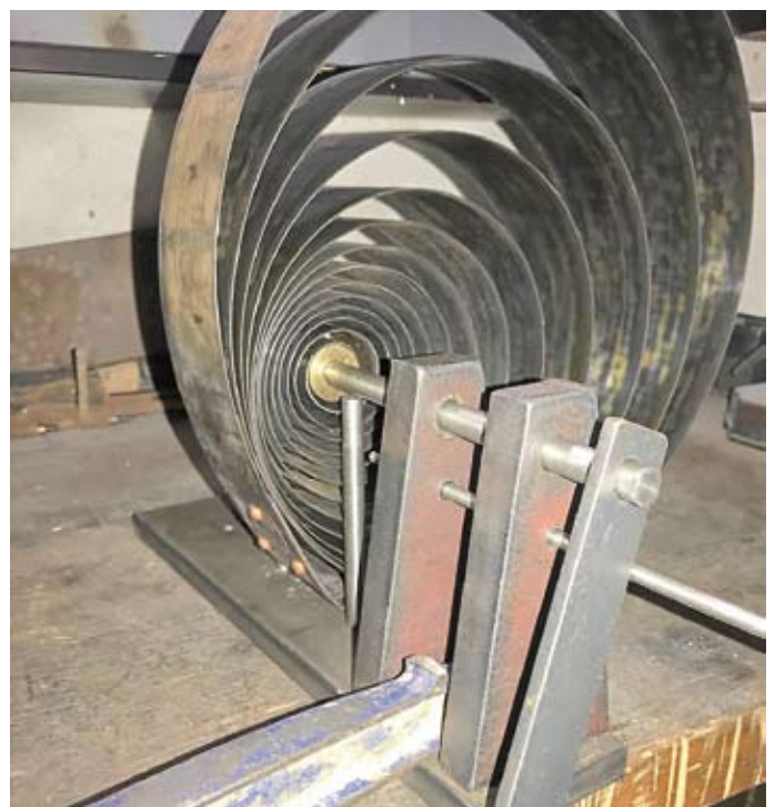
Abb. 7: Federwinder (Eigenkonstruktion für Großfedern)
