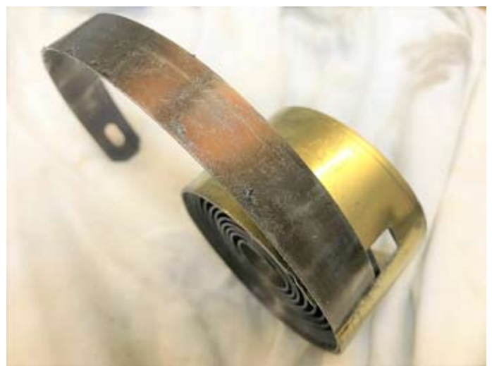
Abb. 6: Geschlitzte Hülse mit Feder, vorbereitet zum Einbau in ein Messing-Federgehäuse
