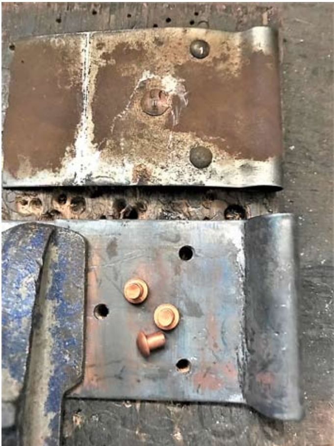
Abb. 5: Federanfang mit neu geformter Öse und Sicherung mit drei Kupfernieten
