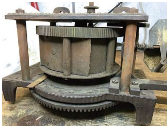
Abb. 4: Federbruch am Polyphon Motor
