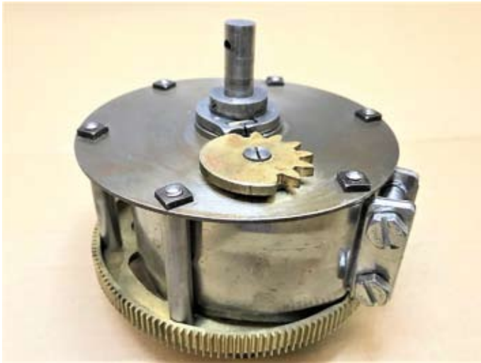
Abb. 8: Neue Feder im Federkäfig mit Stahlschelle gesichert
