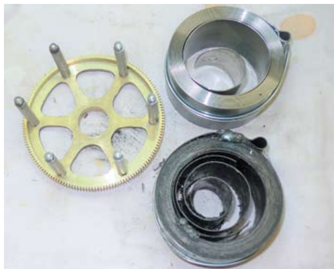
Abb. 3: Federkäfig, zusammenschweißte Feder und gesicherte, neue Feder
