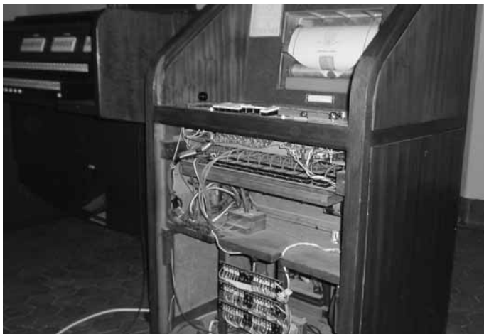
Abb. 2 Gesamtansicht des Orgelspielapparates von Barbieri, Modell „Cantantibus Organis“, im Besitz von AMMI. Das restaurierte Exemplar enthält ausschließlich Originalteile und ist vor kurzem mit einem MIDI-Interface ausgestattet worden.
