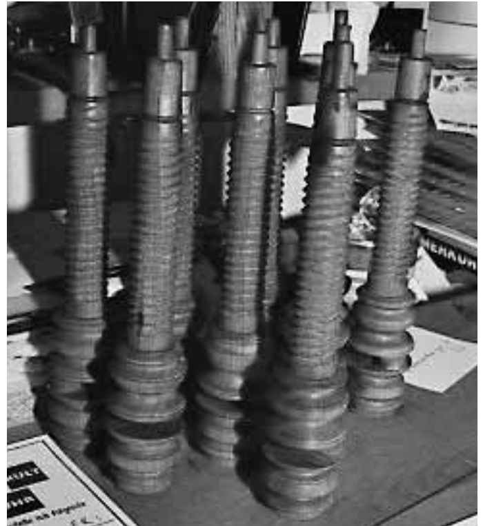
Schneckenriebe mit geschnittenem Gewinde und ausgearbeitetem Exzenterzapfen
