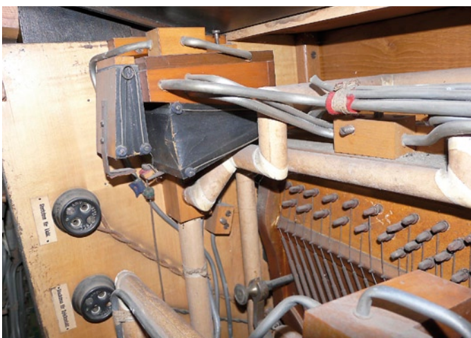
Abb. 18: Popper Stella, Bass-Betonungseinheit mit senk-rechter Zugstange für Betonungsventil. (Foto Schmitz)
