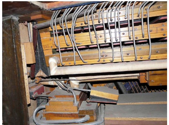
Abb. 19: Popper Stella, Bass-Regelbalg mit waagerechter Zugstange zum Betonungsventil. (Foto Schmitz)
