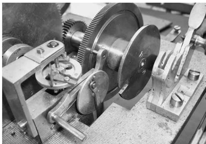
Abb. 9: Fliehkraftregler und Kurbelscheibe mit verschiedenen Achspunkten für die Pleuelstange
