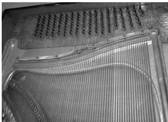
Abb. 23: Klavierrahmen, Saiten und Stimmwirbel eines Piano Melodico mit 73 Tönen.
