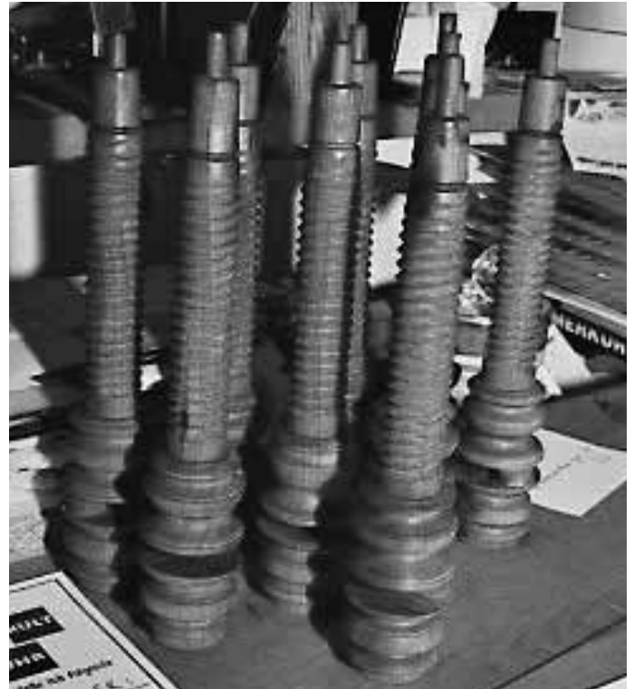
Schneckenriebe mit geschnittenem Gewinde und ausgearbeitetem Exzenterzapfen
