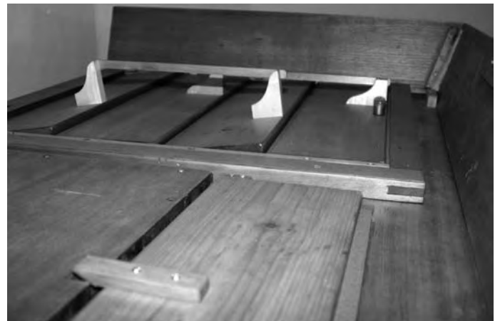
Die drei unabhängigen Schweller: Vorne der „Akzent“ (Spur 42), dahinter je zwei Lamellen für Spur 7/8 und Spur 87.
