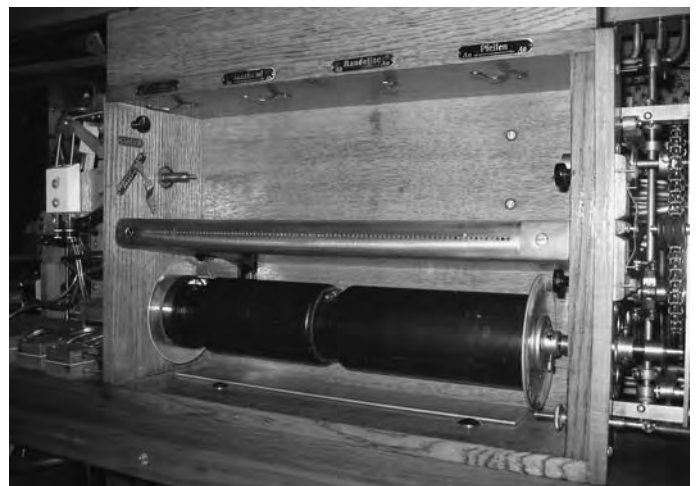
Der Notenkasten mit den Schaltern zum Anpassen des Instruments an die Notenrolle.
