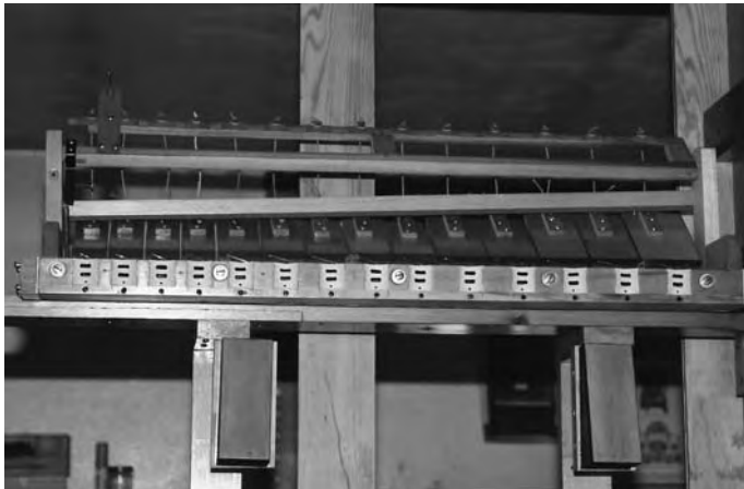
Die Tonsteuerung für das Flex-a-ton - hier noch ohne Alu Ventile - und Verrohrung.
